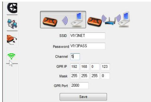
Frente a la necesidad de utilizar otro identificador de red (SSID), la contraseña de la red u otras configuraciones de la misma, cambie lo necesario en la ventana de configuración WiFi y haga click en el botón Save.
