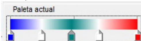
El uso de varios colores de la paleta permite identificar la amplitud de la señal con color. Por ejemplo, se puede resaltar los picos máximos de media onda positiva con color azul, negativa con rojo, y la zona nula con verde.
